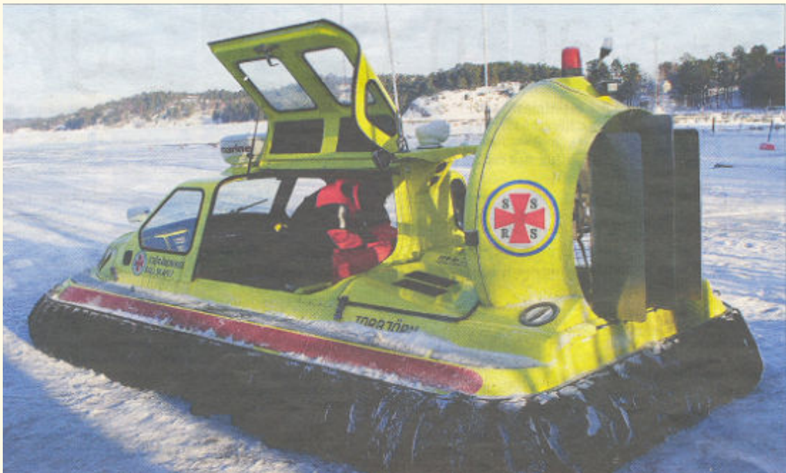
Utan snö på isen har svävaren en maxfart på 60 knop och marschfarten ligger runt 30 knop.
